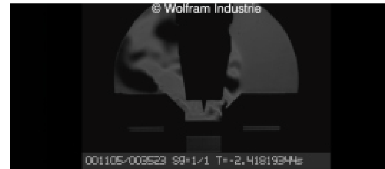
Damit etwa der Elektrodenverschleiß, die Schutzgaseinflüsse oder Schutzgasturbulenzen überhaupt erfasst werden können, ist eine Auflösung von mehr als 1000 Datenpunkten pro Sekunde erforderlich. © Wolfram Industrie
