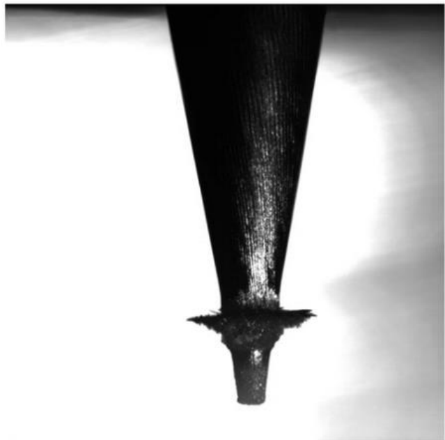
Oxidation einer Wolframelektrode
