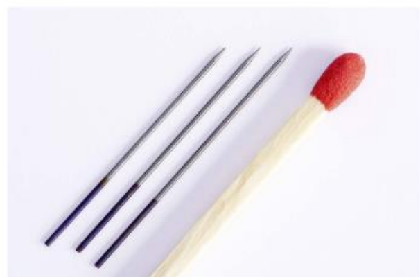
Größenvergleich zwischen PUKStar-Elektrode und Streichholz. Die Elektroden haben einen Durchmesser von 0,6–1,0 mm.
