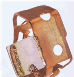
Auch und besonders bei Werkstücken mit Materialstärken bis 0,1 mm sind qualitativ hochwertige Schweißnähte oder Schweißpunkte gefordert. © Lampert Werktechnik
