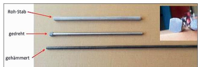
Über die bisherige Technik hinaus gelang ein neues Konzept für das Sintern und den zwischengeschalteten Umformprozess. Dadurch sind erstmalig Umformgrade von 63 % und mehr möglich. Mit diesem Verfahren wurden Bauteile mit 720 mm Länge bei einem Durchmesser von 10,5 mm erreicht.
